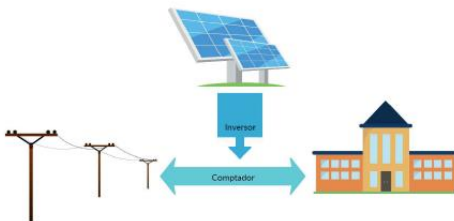
Il·lustració 13. Esquema bàsic d'injecció a xarxa
